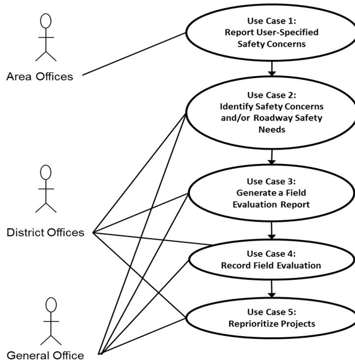
**Figure 7.3 Use Case Diagram**
