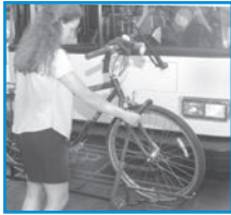
3. Asegure la bicicleta trabando la barra sobre el neumático.
