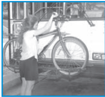
2. Cargue la bicicleta colocando las ruedas en las ranuras.
