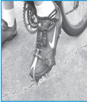
Las punteras aseguran el pie al pedal y brindan más fuerza
