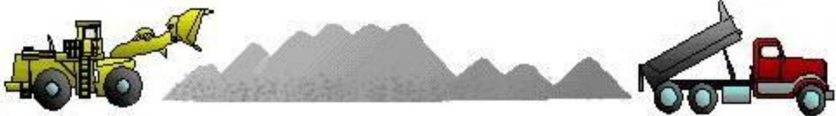
**DON'T** LET MATERIAL ROLL FROM THE TOP TO THE BOTTOM OF THE STOCKPILE
